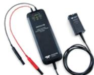
可提供  $1,2$  或  $6\text{ kV}$  共模电压输入范围，高频时优异的 CMRR ( $65\text{ dB}$  @  $1\text{ MHz}$ ) 与低固有噪声、宽差分电压范围、高偏置电压能力和  $1\%$  的增益精度相结合，是功率转换系统测试的理想探头。
