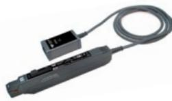
可提供高达  $100\text{ MHz}$  带宽、 $700\text{ A}$  峰值电流和灵敏度到 1 毫安/格，某些型号提供超长电缆 (3 或 6 米)，适用于器件或电源转换系统输入/输出测量，同时提供 DCS025 偏移校准源。
