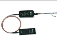
HVF0108 是一种紧凑、简单经济实惠的探头，适用于测量浮在电力电子设计中的 HV 总线或者 EMC, EFT, ESD 和 RF 抗扰度测试传感器监控上的小信号 (门驱动, 传感器等)，高达  $35\text{kV}$  的共模电压， $140\text{dB}$  CMRR
